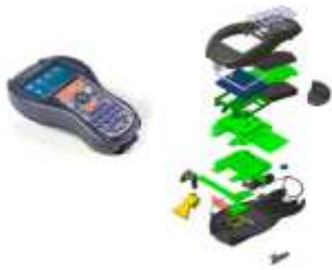
Figura 1- Da Concept Design allo stampaggio [PRODOTTO-CAD ASSEMBLY]
